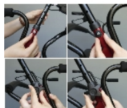
Étapes réglage hauteur des poignées
