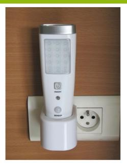
Cette lampe torche est dotée d'un capteur qui déclenche automatiquement un allumage puissant (15 Leds ultra-blanche) lorsqu'un mouvement est détecté à 2/3 mètres tout en étant branché sur son socle. Elle sert également de lampe de poche à son extrémité (5 Leds puissantes).
